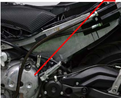
c. 後避震器安裝好後，拆開機油側蓋，阻尼控制油管穿越其間，再將側蓋鎖上。
