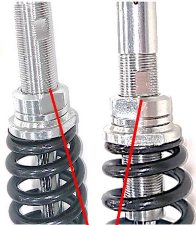
e. 預載最大(左圖)及最小(右圖)狀態，可調整範圍約20mm.
