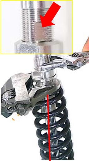
c. 先以扳手夾持螺桿平面處，若要增加預載時(變硬)，則以**另一扳手**以順時針方向將下方螺帽向下旋轉；反之若要減少預載(變軟)時，則以逆時針方向旋轉。
