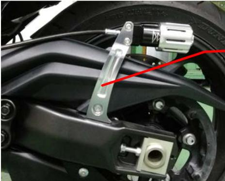
e. 預載調整器則以固定支架固定於車架之後搖臂上。油管則繞由機油蓋後方，並以束帶固定於腳踏架上。
