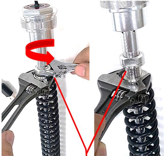
b. 以扳手固定住下方螺帽，再以另一扳手以逆時針方向將上方螺帽鬆開，如右圖所示。
