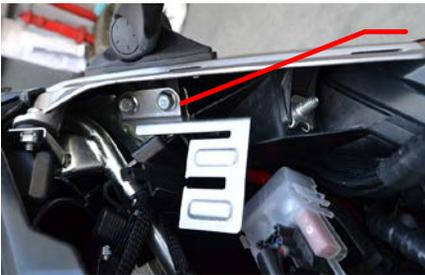
c. 將控制盒支架安裝於左邊後照鏡之固定座(使用原車之固定螺絲)
