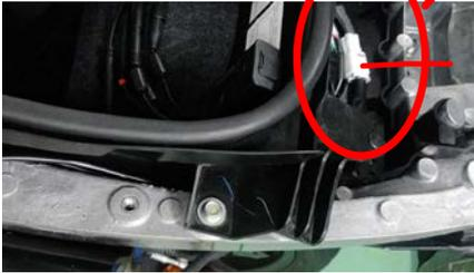
b. 將主線組上的R-MOTOR 1接頭與後避震器上的F-MOTOR 1馬達線接頭連接；主線組上的R-MOTOR 2接頭與後避震器上的R-MOTOR 2馬達線接頭連接
