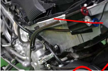
a. 佈線：將貼有R-MOTOR 1及R-MOTOR 2之電線，沿著左邊車腹內向後方佈線，並將接頭佈置於座椅下方置物箱後方之空間。
