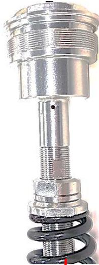
d. 調整完成後，再將上方螺帽向下旋轉，並使上下二顆螺幅迫緊
